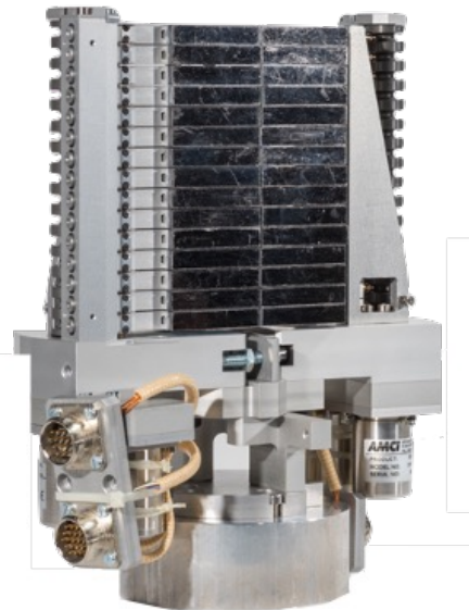
HOPG Monochromator 30 HOPG crystals ( 42 \times 8 \times 2 \text{ mm}^3 )
